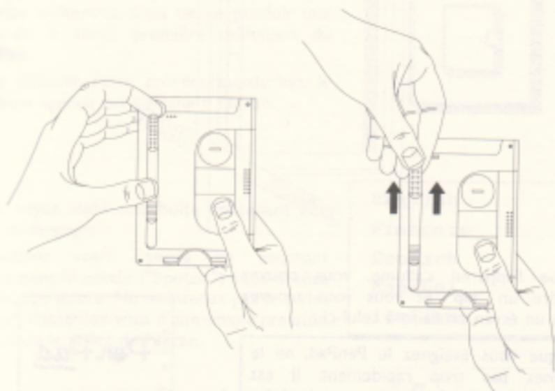
Pressez l'arrière du système de fermeture pour libérer et ouvrir le couvercle.
