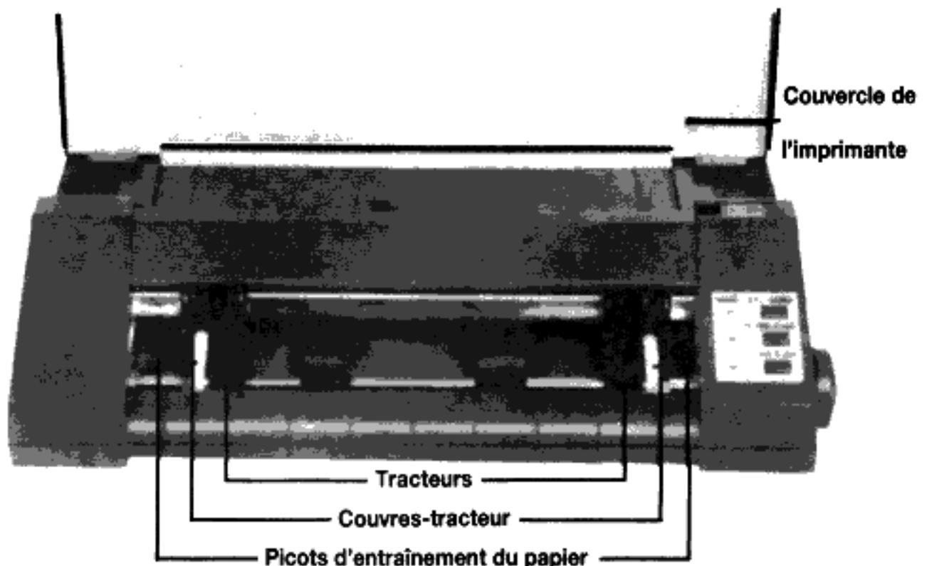
Les picots d'entraînement du papier sont maintenant apparents. Ensuite, alignez les perforations du papier sur les picots, et si nécessaire, déplacez les tracteurs.
