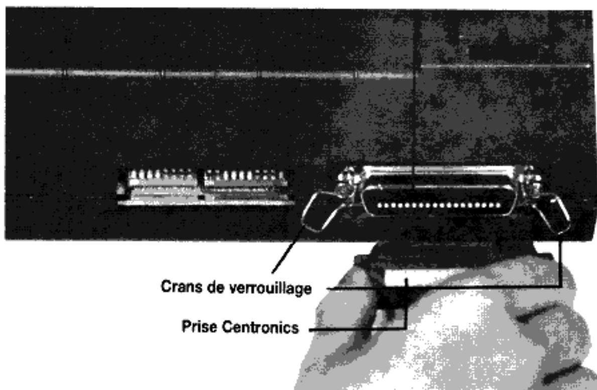
Branchez l'autre bout du câble (ou de l'interface parallèle) dans votre ordinateur. Si vous utilisez la DMP2160 avec un ordinateur AMSTRAD, insérez le connecteur (au bout du câble PL-1) dans la prise marquée **PRINTER** au dos de l'ordinateur, le câble doit ressortir sous la prise.
