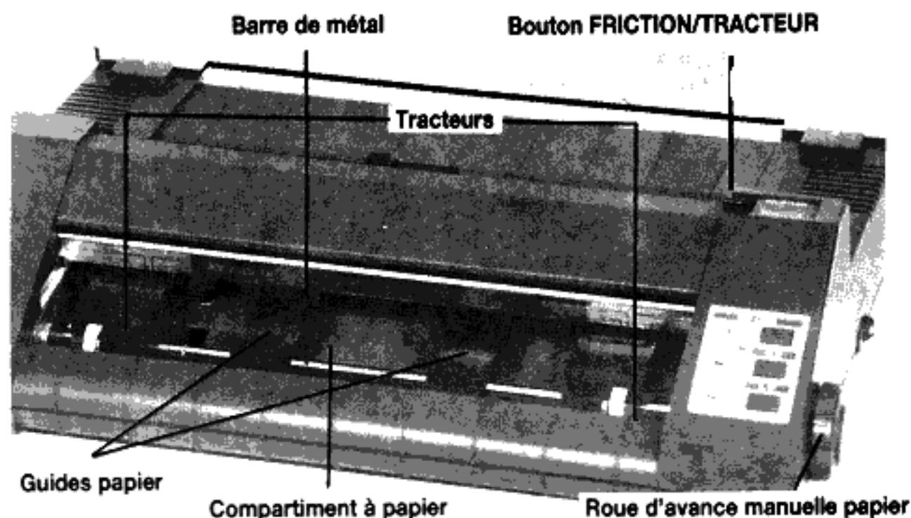
Les deux blocs en plastique du bout sont appelés des tracteurs, et peuvent être déplacés vers la droite ou la gauche suivant la taille du papier que vous utilisez.
