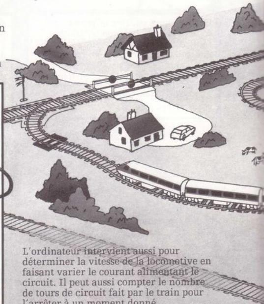
L'ordinateur intervient aussi pour déterminer la vitesse de la locomotive en faisant varier le courant alimentant le circuit. Il peut aussi compter le nombre de tours de circuit fait par le train pour l'arrêter à un moment donné.
