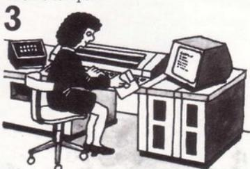
Un mini-ordinateur est une version plus petite de gros systèmes. Il ne comporte que quelques boîtiers de circuits imprimés et est plutôt utilisé pour réaliser un type défini de tâches (comptabilité ou la constitution et la gestion de banques de données).
