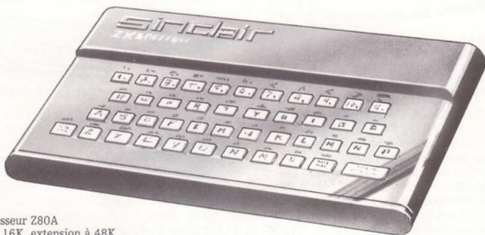
Comme le ZX81, le Spectrum dispose d'un clavier alphanumérique portant aussi des instructions et des fonctions BASIC. Il permet de créer des images en couleur (8 programmables) avec un téléviseur SECAM muni d'une prise Péritel. Outre ses interfaces magnétophone, imprimante et TV, il dispose d'entrées/sorties pour des
