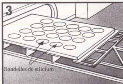
Les dessins des circuits sont reproduits sur les puces par procédé photographique avant que les rondelles de silicium soient introduites dans un four. Ensuite un ensemble de phénomènes chimiques permettra aux circuits de se graver dans le silicium.
