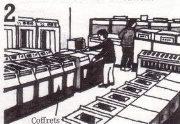
Les gros ordinateurs utilisés dans l'industrie comportent des centaines de plaques de circuits imprimés réunies dans des coffrets disposés en rangées dans des locaux réservés au matériel informatique. Ces calculateurs peuvent réaliser une grande quantité d'opérations en même temps.
