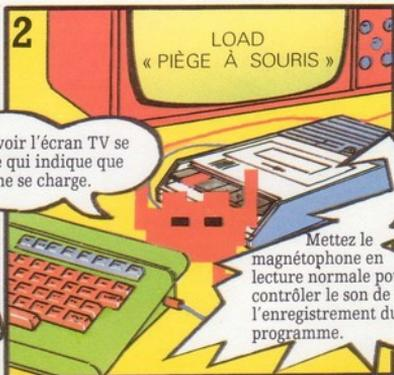
Un programme est conservé dans une cassette sous la forme de séries d'impulsions à haute fréquence. Pour le charger sur votre ordinateur, connectez le magnétophone en suivant la notice explicative, placez le potentiomètre entre 7 et 8 et la tonalité dans les aigus. Quand vous tapez LOAD suivi du nom du
